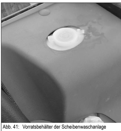
Abb. 41: Vorratsbehälter der Scheibenwaschanlage
