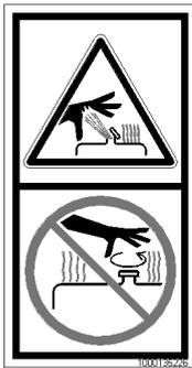
Abb. 16: Hydrauliktank steht unter Druck
