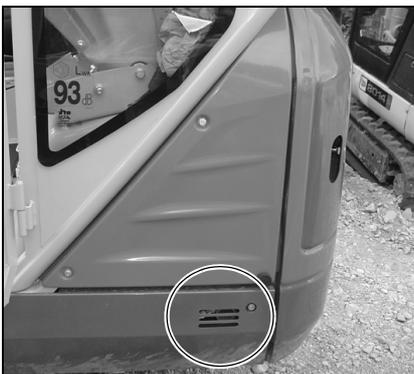
Abb. 112: Luftansaugung Motor
