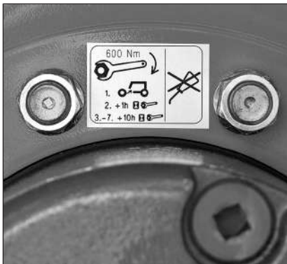
Abb. 339: Aufkleber Anzugsdrehmoment
