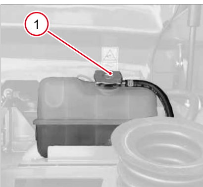
Abb. 300: Einfüllöffnung für Kühlfüssigkeit
